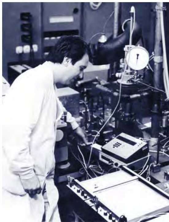
Obr. 2 Jan Hála optimalizuje nastavení optiky na vstupu monochromátoru. (Fotografie z 80. let 20. století.)
