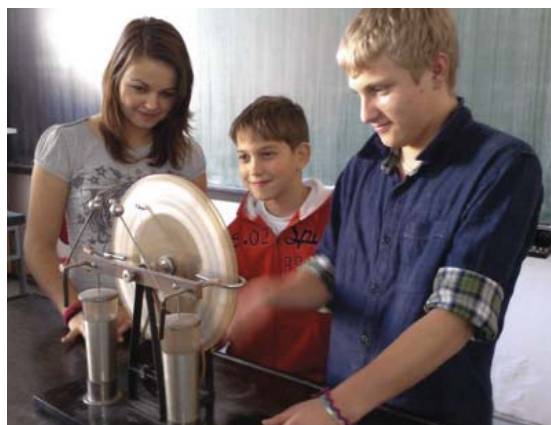
Demonstrace jiskrového výboje pomocí Wimshurstovy indukční elektriky.
