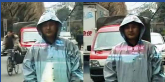
Obr. 1 Kamufláž podle profesora Susumu Tachi z univerzity v Tokiu. Na přední stranu předmětu je promítnuta počítačově zpracovaná scéna za ním.
