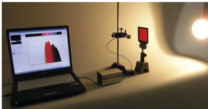
Obr. 1 Meranie spektra svetla prechádzajúceho absorpčnými filtermi školským spektrometrom Spectra-1.
