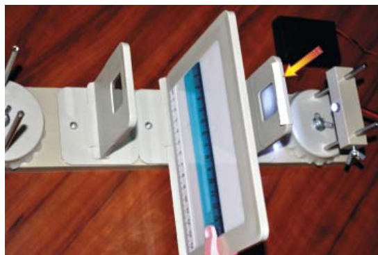
Obr. 1 Experimentální složení části experimentální úlohy ze 45. MFO. LED dioda jako zdroj světla je zcela vpravo.
