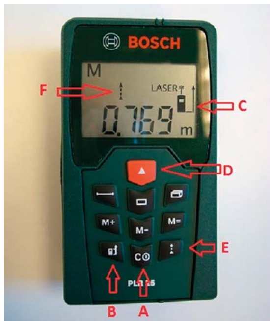
Obr. 1 Laserové délkové měřidlo. Šestice neoznačených tlačítek je pro vás zcela irelevantní (slouží k měření ploch a objemů). Relevantní tlačítka jsou: A : Vypínač (On/off); B : Přepínač mezi měřením od zadního a předního konce přístroje; C : Ukazatel módu měření od předního/zadního konce; D : Zapnutí laseru / začátek měření; E : Kontinuální (souvislé) měření; F : Ukazatel kontinuálního měření
