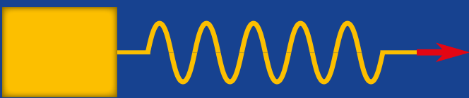
Obr. 1 Kostka tažená po stole na pružině, jejíž druhý konec se pohybuje konstantní rychlostí, poslouží jako velmi dobrý model vrzajících dveří.
