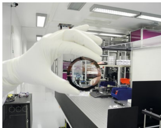
Obr. 1 Keramická deska Yb:YAG ve tvaru válce s tloušťkou 0,5 cm vyrobená firmou Konoshima Chemicals. Spolu s dalšími třemi podobnými deskami vytváří aktivní laserové prostředí v hlavním zesilovači HZ1 laserového systému Bivoj.
