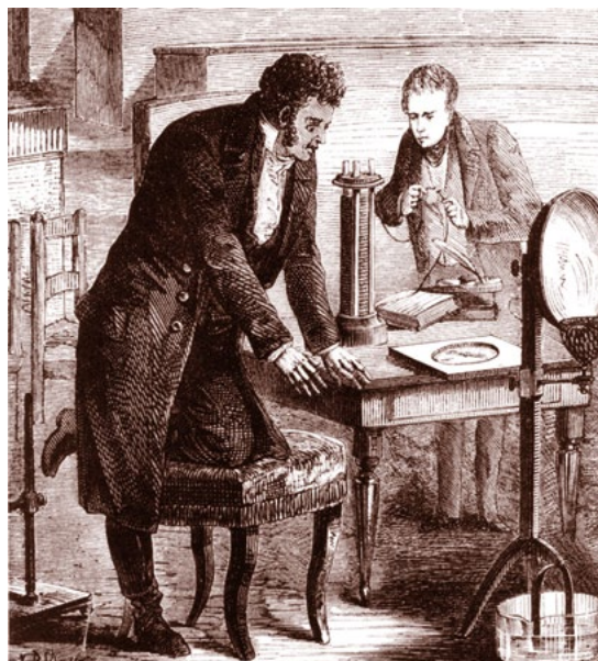
Obr. 2 Oersted při pokusu s Voltovým sloupem, vodičem a magnetkou.
