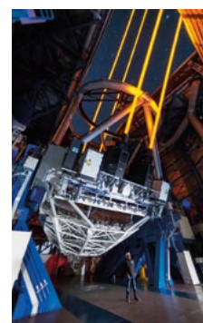
Čtyři umělé laserové hvězdy na teleskopu VLT, v chilském Paranalu. Moderní systémy adaptivní optiky využívají pokročilá schémata řízení a kombinují hned několik senzorů vlnoplochy, fázových korektorů i umělých hvězd. Kredit: ESO/F. Kamphues
