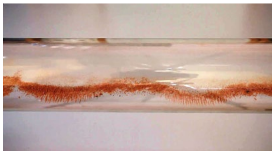
Obr. 1 Zvukové vlny zviditelněné pomocí jemných korkových částic.
