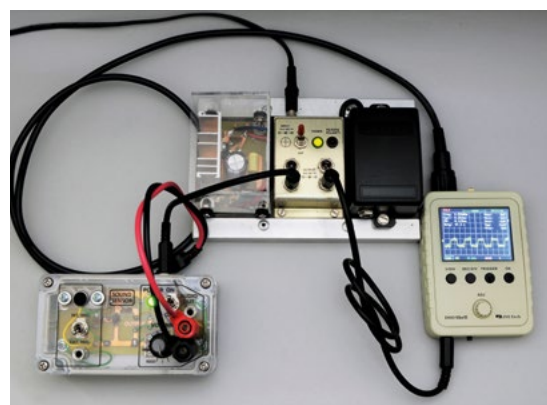
Obr. 2 Rušenie spôsobené osciloskopom DSO 150.
