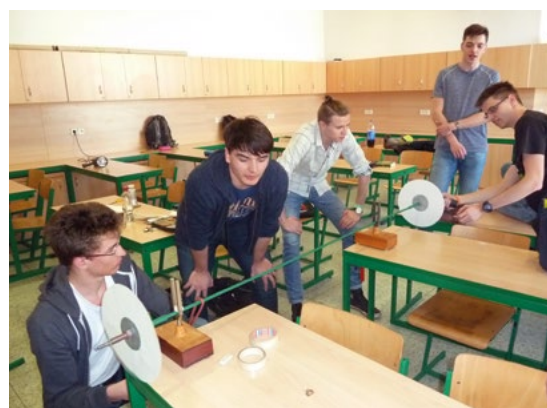
Obr. 2 Měření rychlosti střely pomocí dvojice rotujících kotoučů.
