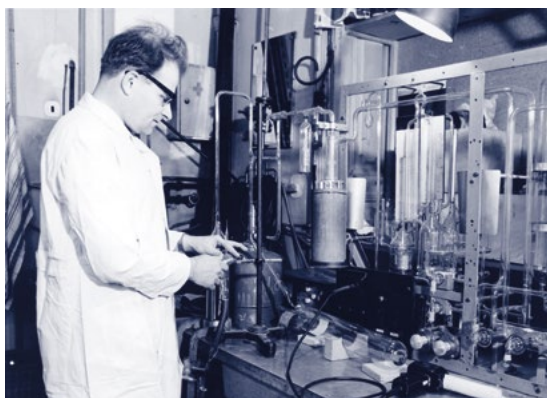
Obr. 1 Asistent Libor Pátý v laboratoři u své skleněné kalibrační a plnicí vysokovakuové aparatury na počátku 70. let. Zdroj: Archiv MFF UK
