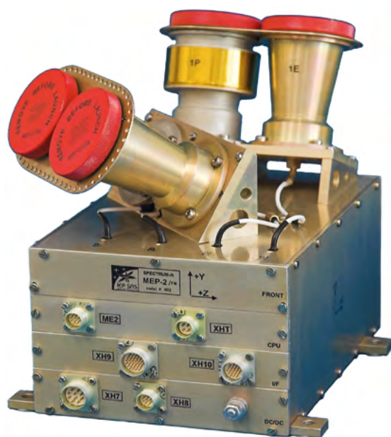
Obr. 1 Programovateľný spektrometer kozmických energetických častíc MEP-2 skonštruovaný na ÚEF SAV úspešne pracoval na palube satelitu Spektr-R / Radioastron takmer 8 rokov. Zdroj: ÚEF
