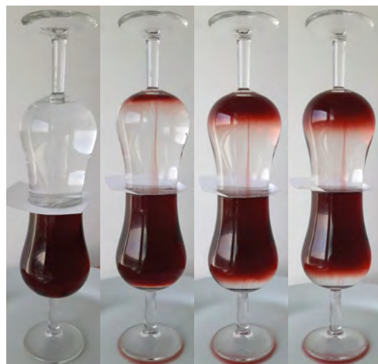
Obr. 1 Částečná výměna vody a červeného vína v důsledku jejich rozdílné objemové hustoty hmotnosti. Červené víno má typicky menší hustotu než voda z kohoutku. Dvě skleněné číše jsou odděleny kusem běžného kancelářského papíru, který je mírně povytažen tak, aby se voda a víno dostaly u stěny sklenic do přímého kontaktu. Je vidět, že červené víno proudí směrem nahoru. Nahoře se vytváří vrstva červeného vína a u dna spodní číše vrstva vody. Nedojde ale k výměně veškeré vody za víno, dochází totiž také k difuzi.
