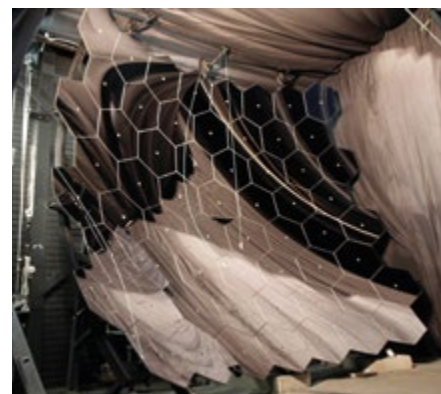
Obr. 3 Fotografie byla pořízena v průběhu justáže zrcadlových segmentů na prvním teleskopu projektu HEAT v Argentině.
