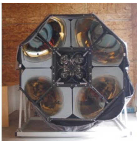
Obr. 2 Zrcadlový systém detektoru projektu FAST, který je instalován v rámci projektu TA (Teleskop Array) v Utahu.
