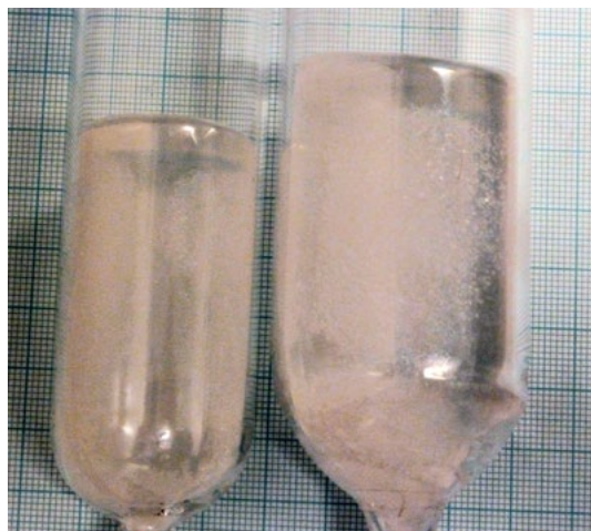
Obr. 1 Monokrystal kalomelu v růstových ampulích a finální kalomelový výbrus.
