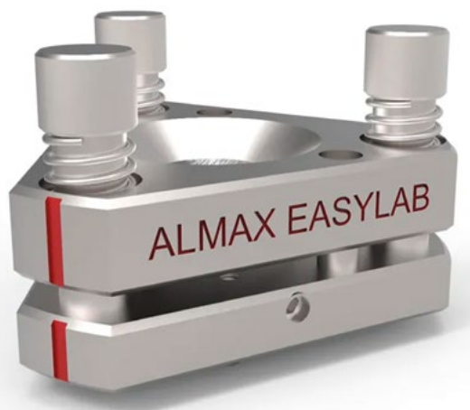
Diamantová tlaková cela Diacell Diasqueeze FTIR pro spektroskopická měření. Zdroj: https://diamondanvils.com
