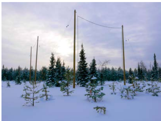
Obr. 1 Magnetické smyčky orientované ve směru sever–jih a západ–východ, umístěné za polárním kruhem ve finské měřicí stanici Kannuslehto (67,7°N, 26,3°E). Jedna strana čtvercové smyčky má délku 10 m. Každá anténa má 10 závitů. Efektivní plocha každé ze smyček je 1 000 m 2 . Signál z antén zpracovává citlivý rádiový přijímač. Fotografie byla pořízena během polárního dne.
