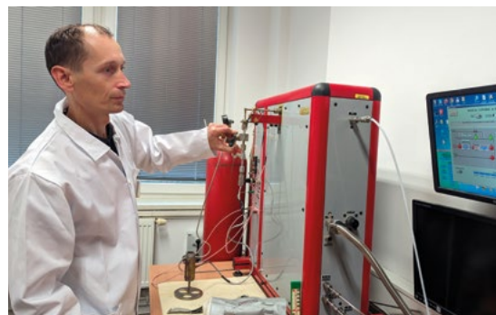
Obr. 2 Měření kinetických a termodynamických vlastností ukládání vodíku se provádí pomocí přístrojů založených na Sievertsově metodě.
