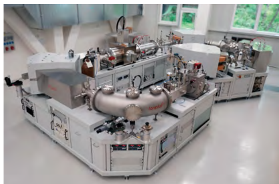
Obr. 1 Atomový hmotnostní spektrograf MILEA v ÚJF AV ČR. Zdroj: [2]
