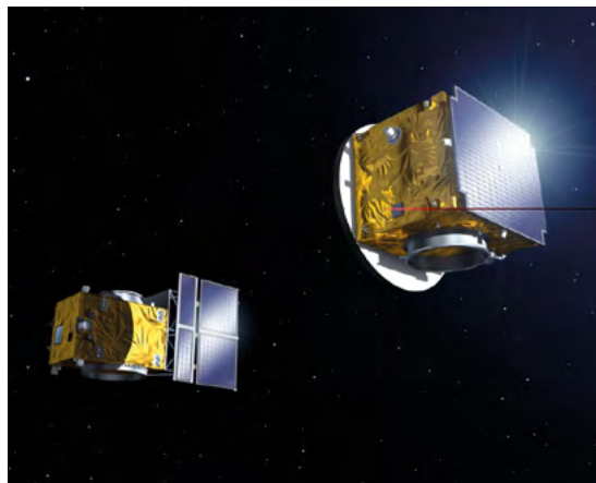
Obr. 1 Díky přelomové technologii vysoce přesného letu satelitů ve formaci dokáže mise Proba-3 a její koronograf ASPIICS pozorovat sluneční korónu v bezprecedentním detailu.
