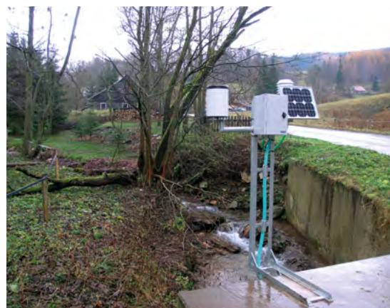
Obr. 2 Limnigrafická stanice lokálního varovného systému pro předpověď přívlových povodní. NP Krkonoše
