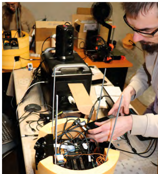
Obr. 1 Vnitřní uspořádání gondol stratosférických balonů MORANA 2 a 3 konstrukčně odpovídá logice, se kterou jsou sestavovány cubesaty.
