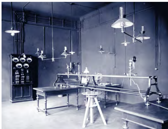
Obr. 1 Fotometrická laboratoř Fyzikálního ústavu české Karlo-Ferdinandovy university v tehdy nové budově na Karlově (kolem r. 1920). Optická lavice slouží k porovnávání světelného toku z „normálu“ (Hefner-Altenckova normální svíčka, vlevo) a zkoumaného zdroje (žárovka vpravo) pomocí Lummerova–Brodhunova fotometru (zhruba uprostřed snímku). Za pozornost stojí osvětlení místnosti kombinací plynových lamp (ty s komínky) a elektrických žárovek. Zdroj: Archiv MFF UK
