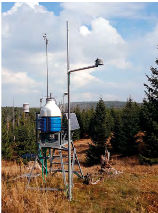
Obr. 1 Experimentální stanice měřící meteorologické veličiny a nasycení půdního profilu. NP Šumava
